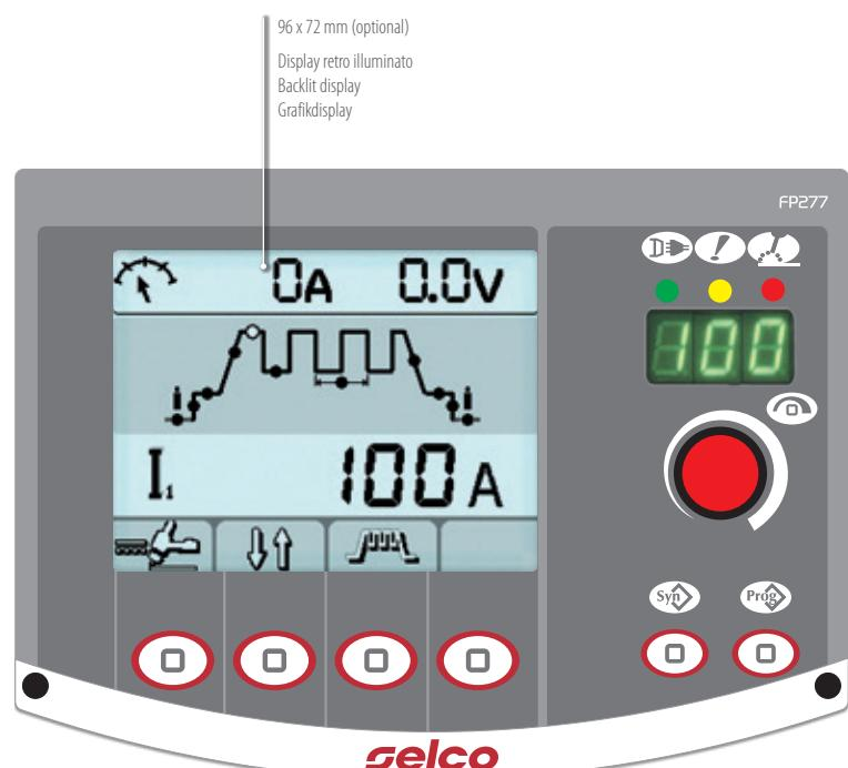
iPanel visualizza tutti i principali valori del processo di saldatura con caratteri, cifre e simboli grandi e chiari, presentati in modo sinottico, con una unica visione complessiva si ottiene quindi il controllo completo del processo.
