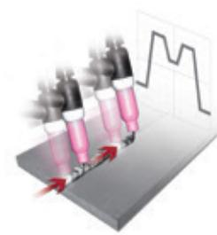
Ermöglicht das Erreichen einer größeren Glättung des Grundmaterials oder höheren Schweißleistung, während der Durchschnitts-Stromwert unverändert bleibt.
