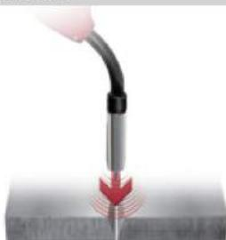
Questo innovativo controllo della fase di partenza garantisce inneschi sempre sicuri e la riduzione degli spruzzi di saldatura.
